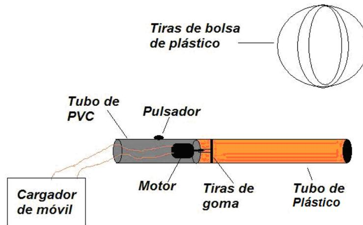
Se basa en: el motor al girar hace que las tiras de goma rocen con el tubo de plástico y se genera electricidad estática. Esta electricidad carga las tiras de la bolsa de plástico, que como tienen la misma carga se repelen haciendo que la bolsa levite. Funcionará mientras el tubo de plástico no toque la pieza que levita.7
