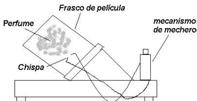
El alcohol de 96° es un excelente combustible. El "truco" consiste en sostener el spray a una distancia de unos 8 centímetros del frasco de película, para que el alcohol se vuelva gas en el interior del frasco.
